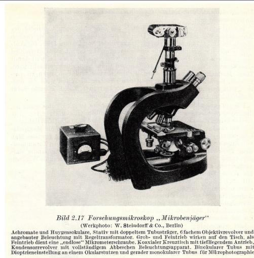
Figure 20. The Steindorff Microbe Hunter depicted in: Otto, L. (1959). *Durchlichtmikroskopie. Geräte und Verfahren*, Berlin, Veb Verlag Technik
